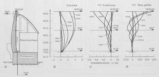
Bild 1. Horizontale Radialformationen im Hauptschnitt der Bogenstaumauer Ova Spin (a) für verschiedene Stauziele (b) bzw. Einheitstemperaturänderungen und -gefälle auf verschiedenen Mauerhöhen (c und d) auf Grund eines sechsschnittigen radialen Lastausgleichs
