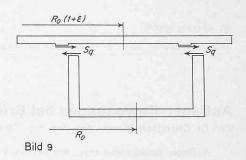
und Rippen Querschubkräfte  $S_q$  wirken, die im Querschnitt Quermomente und im Träger Torsionsmomente auslösen (Bild 9). Analoge Probleme entstehen natürlich auch bei quervorgespannten Fahrbahnplatten gekrümmter Brücken, da die Quervorspannung eine Reduktion der Krümmung der Fahrbahnplatte bewirkt.
