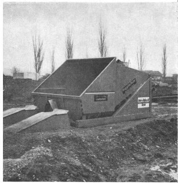
Umschlaggeräte Huggler 4, 5 und 6 Kubikmeter mit oder ohne Druckluftbremse, absolut verwindungsfrei
