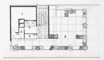
Dachgeschoss 1:300. 1 Ventilatorenraum, 2 Liftmaschinenraum, 3 und 4 Garderoben, 5 Douche, 6 Dachterrasse. — Leider wurde die Bewilligung einer Betriebskantine in einem zusätzlichen Dachgeschoss verweigert.
