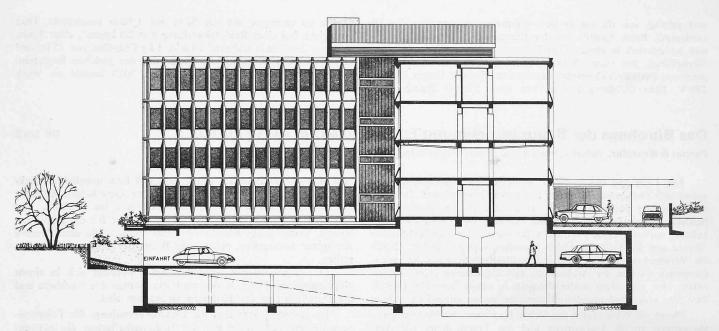
Schnitt 1:300 (in untenstehendem Grundriss von rechts nach links verlaufend!)
