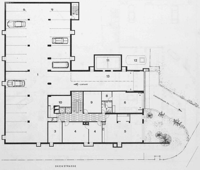
Untergeschoss 1:300. 1 Einstellgarage, 2 Schleuse, 3 Telephonautomat, 4 Archive, 5 Lichtpausraum, 6 Autowaschraum, 7 WC-Anlage, 8 Abstellraum, 9 Modellraum, 10 Elektroverteilung, 11 Öltankraum, 12 Benzintank, 13 Abfahrtsrampe zum Keller (vorgesehen). — Archive, Heizung, Sanitärverteilung und Luftschutzräume befinden sich im Keller (vgl. Schnitt)
