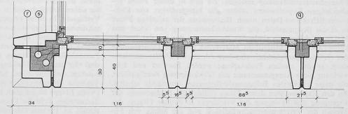
Rechts: Horizontalschnitt durch Fassade, Massstab 1:25. Darüber Vertikalschnitt der Fassade, 1:25
