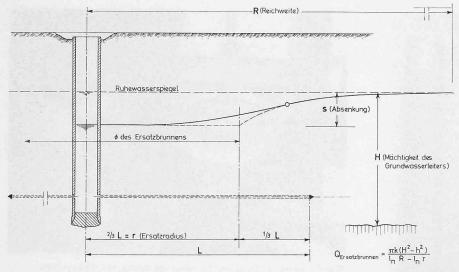
Bild 8. Abschätzung der Ergiebigkeit eines Horizontalbrunnens
