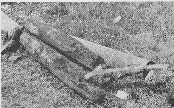
Bild 7. Auswirkungen von aggressivem Grundwasser auf verzinkte Stahlrohre
