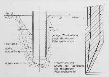
Bild 1. Schachtabsenkung mit thixotropem Flüssigkeitsmantel
