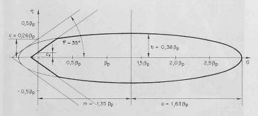
Bild 1 (oben). Bruchfigur einer schmalen, an der Querdehnung behinderten Mörtelfuge. Querdehnungszahl des Mörtels  $\nu=\sigma_x$  /  $\sigma_y=$  0,18
