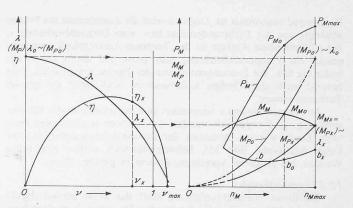
Bild 13. Zusammenarbeit eines Wandlers mit sekundärer Rückwirkung mit einem Verbrennungsmotor Bezeichnungen:
