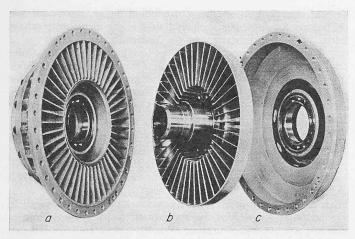
Bild 3. Läuferteile einer Strömungskupplung a Primärrad (Pumpenrad), b Sekundärrad (Turbinenrad), c Primärschale
