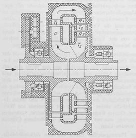
Bild 14. Aufbauschema eines dreistufigen Strömungswandlers
