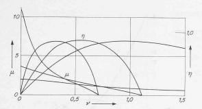
Bild 10. Original-Kennlinien von Wandlern mit verschiedener hydraulischer Grundübersetzung
