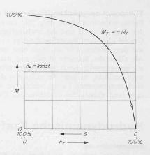
Bild 4. Kennlinie einer Föttinger-Turbokupplung (Drehmoment-Schlupf-Charakteristik)
