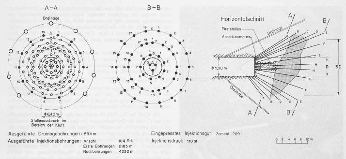
Bild 8. Druckstollen Sampuoir. Umfahrung der Kluft bei Stollenmeter 306. Bohrschema der ausgeführten Zementinjektionen
