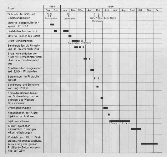
Bild 12. Druckstollen Sampuoir. Programm der ausgeführten Arbeiten bei der Durchfahrung der Kluft bei Stollenmeter 306
