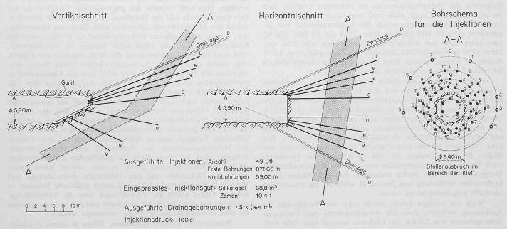
Bild 16. Druckstollen Sampuoir. Schema der Bohrungen für die Konsolidation und Dichtung der Kluft bei Stollenmeter 1993. Massstab 1:600
