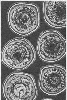
Bild 12. Brennstoffpartikeln für Hochtemperaturreaktoren
