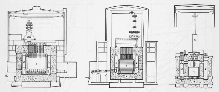
Bild 8. Entwicklung der gasgekühlten Reaktoren, Grössenvergleich zwischen den Anlagen Mark-I-Magnox in Oldbury (links), Mark-II-AGR Dungeness B (Mitte) und Mark-III-HTR (rechts)
