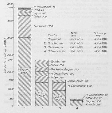
Bild 1. Gesamte auf der Welt in Kernreaktoren installierte elektrische Leistung bis Mitte 1969 und Schätzung bis Ende 1970.1 gasgekühlte Reaktoren, 2 Druckwasserreaktoren (PWR), 3 Siedewasserreaktoren (BWR), 4 Schwerwasserreaktoren
