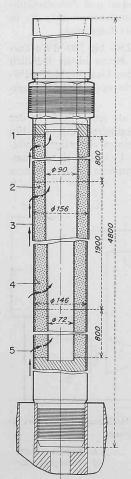
Bild 16. Brennelement für einen gasgekühlten schnellen Reaktor
