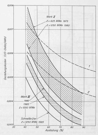
Bild 10. Änderung der Stromerzeugungskosten in Funktion des Auslastungsfaktors
