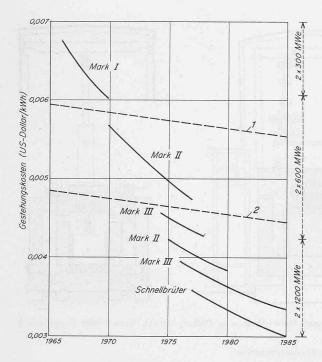
Bild 9. Entwicklungstendenzen der Energieerzeugungskosten nuklearer Anlagen in Funktion deren Grösse. Zugrunde gelegte Daten: Thermischer Wirkungsgrad 42 % (Kernenergie) bzw. 37,5 % (fossil befeuerte Anlagen); Abschreibung 25 bzw. 30 Jahre; Lastfaktor 75 % (beide); Zinssatz 8 % p. a.
