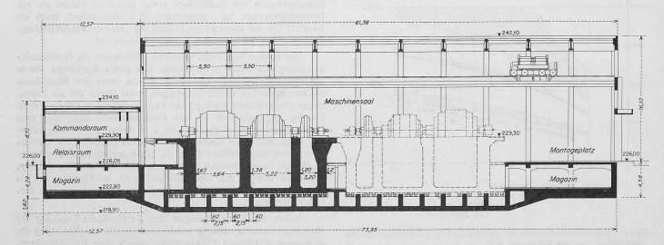
Bild 5. Endgültiger Entwurf des Umformergebäudes, Längsschnitt 1:450
