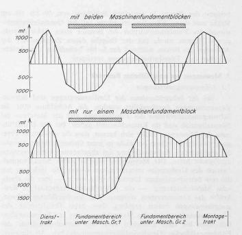
Bild 8. Biegemomente in der Fundament-Tragkonstruktion
