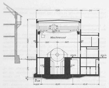
Bild 3. Erster Entwurf des Umformergebäudes, Querschnitt entsprechend der Umformerstation der SBB in Rupperswil, 1:450
