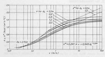
Bild 3. Mit  $^{1/2''}$  dicken Glasfasernmatten isolierte Kanäle k\*=0.241 ln v+0.945  $d_h^{-0.091}$
