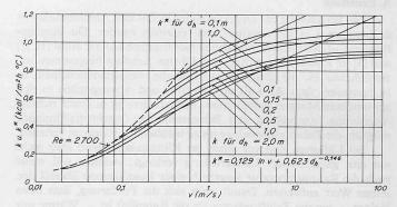
Bild 4. Mit 1" dicken Glasfasernmatten isolierte Kanäle  $k^*=0$ ,129 ln v+0,623  $d_h^{-0,146}$
