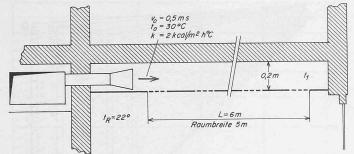
Bild 17. Dem Berechnungsbeispiel 2 zugrunde gelegte gelochte Decke für die Zuluftverteilung
