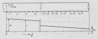
Bild 7. Geschwindigkeitsverlauf im Kanal mit linear abnehmendem Luftstrom und gleichbleibendem Querschnitt
