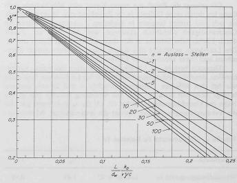
Bild 15. Annäherung der Zulufttemperatur  $t_1$  am Kanalende an jene der Raumluft  $t_R$  im Verhältnis zur Temperaturdifferenz am Kanalanfang  $t_R-t_0$  nach Gl. (27) für spitz sich verjüngende Verteilkanäle mit konstanter Luftgeschwindigkeit v und konstanter Wärmedurchgangszahl  $k_0$
