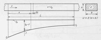
Bild 6. Temperaturverlauf im Kanal mit konstantem Luftstrom und gleichbleibendem Querschnitt
