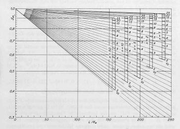
Bild 12. Werte  $\vartheta'_1$  für Kanäle, die mit  $^{1}/_{2}''$  starken Glasfasernmatten isoliert sind
