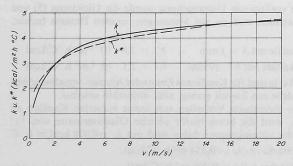
Bild 5. Vergleich zwischen wirklicher Wärmedurchgangszahl k und angenäherter Zahl  $k^*$  für einen Eternitkanal mit  $d_h=0,1$  m.
