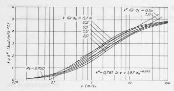
Bild 1. Blechkanäle  $k^* = 0.781 \ln v + 1.97 d_h^{-0.072}$
