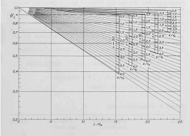
Bild 14. Annäherung der Zulufttemperatur  $t_1$  am Kanalende an jene der Raumluft  $t_R$  wie bei den Bildern 10 bis 13, aber unter der Annahme sehr kleiner Kanalgeschwindigkeiten und eines längs der Kanalachse konstanten k-Wertes. Als Parameter dienen das Verhältnis  $k/v_0$  und die Anzahl Auslassstellen n
