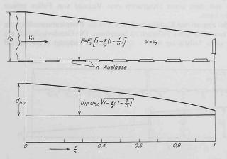
Bild 9. Verlauf des hydraulischen Durchmessers  $d_\hbar$  beim spitz sich verjüngenden Kanal mit linear abnehmendem Luftstrom
