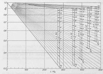
Bild 13. Werte  $\vartheta'_1$  für Kanäle, die mit 1" starken Glasfasernmatten isoliert sind
