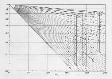
Bild 10. Werte  $\vartheta'_1$  für Blechkanäle
