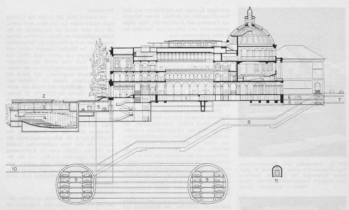
Bild 17. Axialschnitt 1:1000 durch das Hauptgebäude mit den möglichen weiteren Ausbauten: Kommunikationsgeschoss (1), Polyterrasse (2), Cafeteria (3), Grossauditorium (4), Unterführung Leonhardstrasse und Vorfahrt (5), Autoeinstellhalle (6), Fussgängerplattform (7) unter der Rämistrasse mit Rolltreppenverbindung (8) zu Tiefgarage (9), Untergrundbahn und Central (10). Bestehender Eisenbahntunnel (11)
