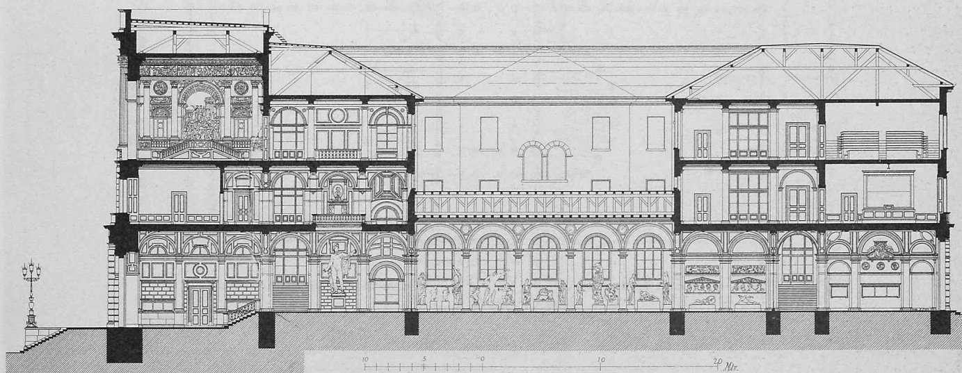
Bild 10. Schnitt 1:450 in West-Ost-Richtung durch den Mitteltrakt mit Antikensammlung (Halle) und Aula
