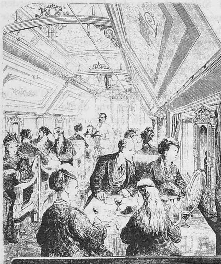
Bild 8. Pullman-Wagen der Pacific-Eisenbahn während des Tages. Die Betten sind über den Fenstern gegen die Decke aufgeklappt, von der das Licht durch den «Clerestory» genannten Aufbau hereindringt
