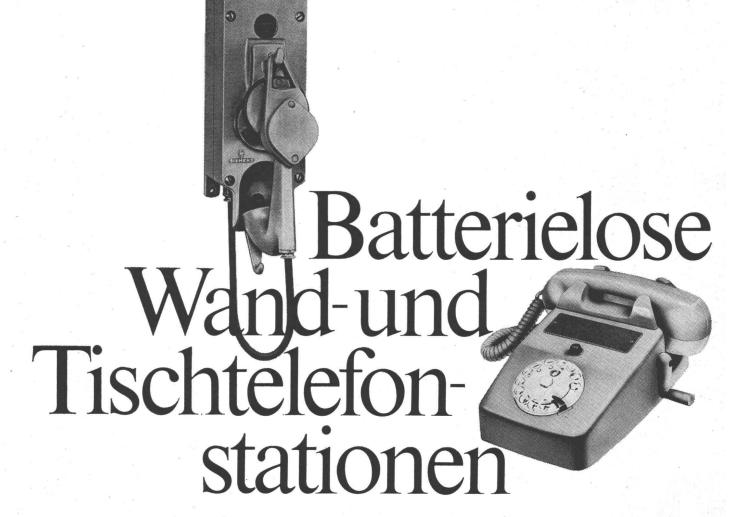
Batterielose Telefonanlagen sind unabhängig von anderen fremden Stromquellen: Der Sprechstrom wird von der im Handapparat befindlichen magnetischen Mikrofonkapsel, der Rufstrom vom Kurbelinduktor in der Telefonstation erzeugt. So ist stets ein sicherer Betrieb gewährleistet.
