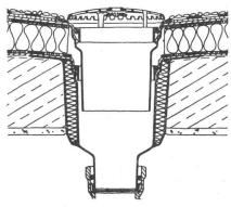
esser's Dachgully, senkrecht, entwässert in der unteren Ebene die "Noteindeckung" und durchfeuchtete Zwischenschichten. Der abschließend eingebaute Gummistutzen mit Flanschkragen entwässert die Dachhaut.
