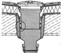
Rollring- und Lippendichtung (siehe Kreis) am GUP-Stutzen schließt das endgültig eingebaute Aufstockelement absolut rückstausicher an den unter der "Noteindeckung" eingebundenen Dachgully an.
