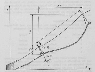
Bild 1. Schematisches Längenprofil mit geometrischen Daten
