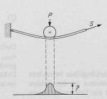
Bild 1c. Weiche Rolle schmiegt sich an Drahtseil an. Biegespannung kleiner als bei Fall b
