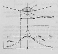
Bild 3. Momentenverlauf  $M_B$  (Maximalwert  $M_{\rm max}$ ) in der Berührungszone und  $M_F$  in der freien Zone des Seiles bei parabolischer Lastverteilung. Die gestrichelte Kurve stellt den Biegeverlauf bei Vorhandensein einer kleinen, harten Rolle (a=0) dar
