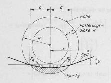
Bild 5. Gefütterte Rolle: Eindrucksprofil dargestellt als Differenz  $F_R - F_S$  zwischen Kreissegment  $F_R$  des Rollenprofils und Flächen  $F_S$  zwischen der elastischen Seillinie und der Sehne
