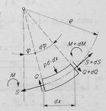
Bild 4. Seilelement durch Zug S und Querlast p  $d \cdot dx$  belastet (bei kleinem Neigungswinkel  $\varphi$ )
