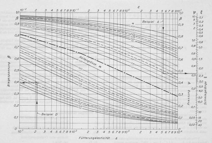
Bild 7. (Dimensionslose) Abhängigkeit der Biegespannung  $\beta$  und der Pressung  $\psi$  von der Fütterungselastizität  $\epsilon$  und der Rollengrösse  $\alpha$  ( $\xi=$  Schmiegelänge-Parameter)
