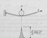
Bild 1b. Dickdrahtiges (hartes) Drahtseil in punktartiger Berührung mit harter Rolle (Fall Isaachsen). Biegespannung unabhängig vom Drahtdurchmesser  $\delta$
