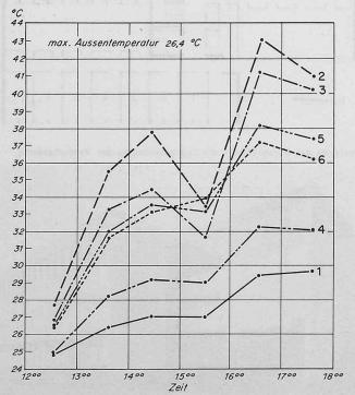
Bild 2. Verlauf der Fenstertemperaturen in den sechs Versuchsräumen.
