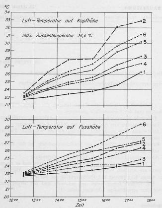
Bild 1. Verlauf der Lufttemperatur in Kopf- und Fusshöhe in den sechs Versuchsräumen. 2. Versuch
