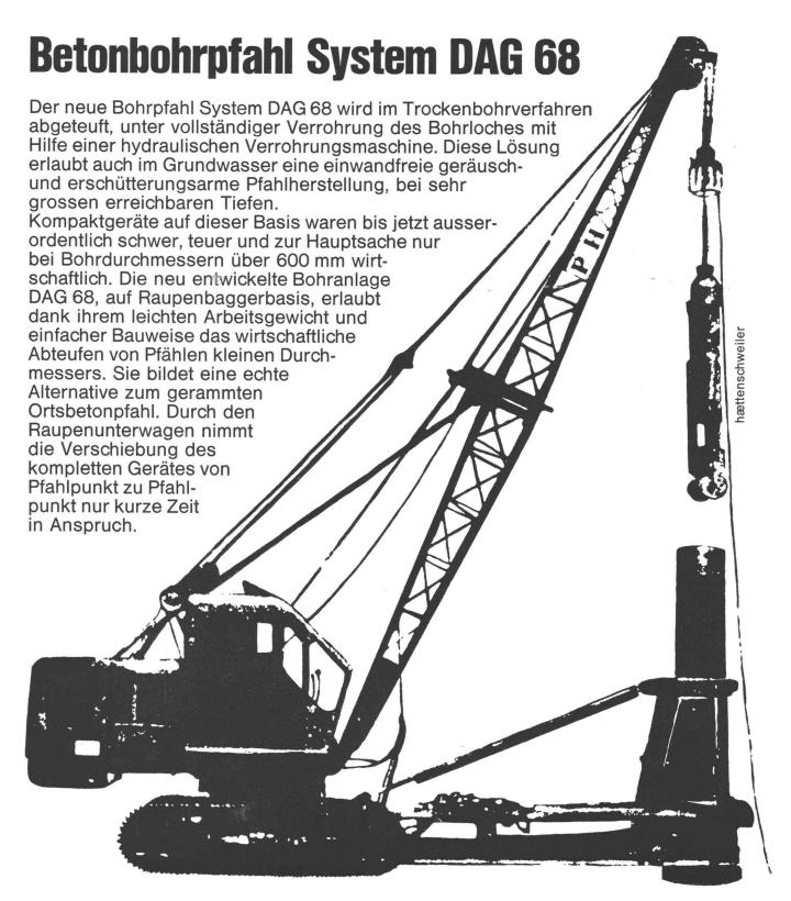
Pfahldurchmesser Tragkraft (inkl. Sicherheiten) Pfahllängen 560 mm, eventuell 700 mm max.120 t bei ∅ 560 mm max.200 t bei ∅ 700 mm über 30 m unteleskopiert Unser weiteres Arbeits-
