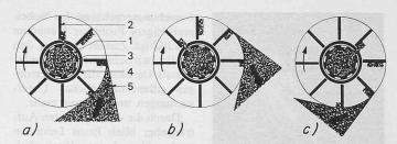
Bild 19. Schleuderradschema des +GF+-Schleuderrades System Wheelabrator. a, b, c Verstellmöglichkeiten des Schleuderbereiches
