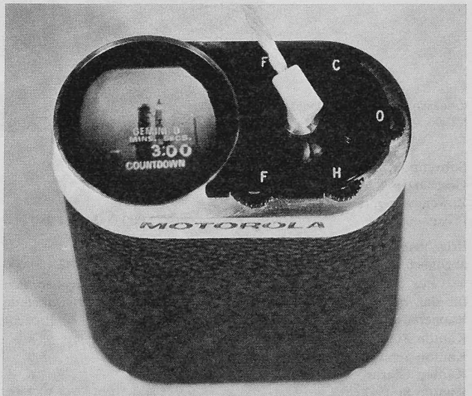
Bild 1. Motorola-Kleinst-Fernsehempfänger mit 1/8"-Bildröhre
