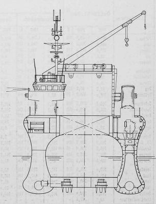
Bild 4. Querschnitt durch die U-Bootskörper und deren Verbindung mit dem Überbau
