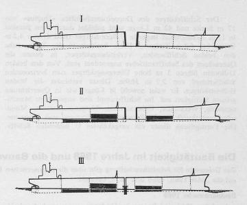
Bild 3. Koppeln der Schiffshälften und Lage des Wasserballastes
