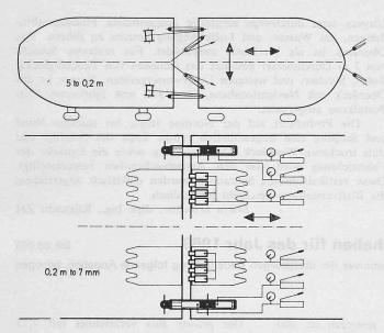
Bild 2. Anordnung der Flaschenzüge und hydraulischen Pressen
