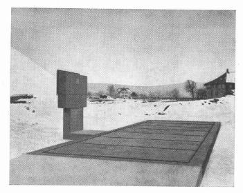
Brücke  $10\times2,8$  m, Laufgewichtsbalken mit parallelgeschaltetem Messkopf
