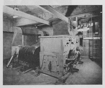
Bild 6. Schüttelsieb, auf welchem der zerkleinerte Kehricht ausgesiebt
