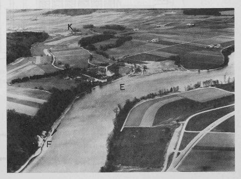
Bild 2. Luftaufnahme des Ramsenerzipfels gegen Nordosten. K Kläranlage, E vorgesehene Einleitstelle in den Rhein, F Färbversuch (die Fahne bleibt über eine lange Strecke erhalten)
