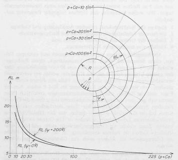
Bild 9. Ausdehnung der Bruchzone in Funktion des Stabilisierungsdruckes
