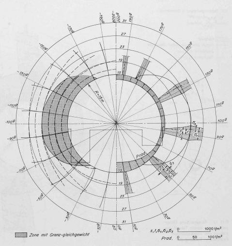
Bild 16. Felsstatische Untersuchung an einem Tunnel, gesichert mit vorgespannten Felsankern. Reibung  $28^g$
