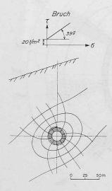
Bild 17. Felsstatische Untersuchung an einem Tunnel, gesichert mit vorgespannten Felsankern. Reibung 39<sup>9</sup>
