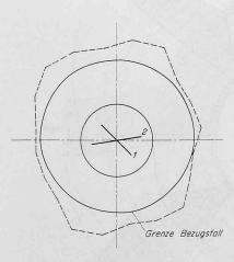
Bild 13. Einfluss von zwei Bruchsystemen in den Richtungen 1 und 2 auf die Ausdehnung der plastischen Zone
