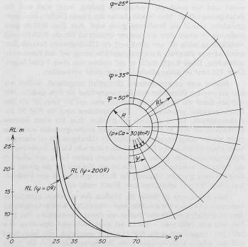
Bild 10. Ausdehnung der Bruchzone in Funktion des Reibungswinkels
