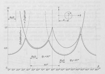
Bild 4. Zwei Systeme von parallelen Kluftflächen ohne Kohäsion
