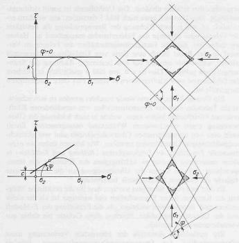
Bild 5. Verformung plastischer Stoffe, Umhüllende und Gleitlinie a) ohne innere Reibung (ideal plastisch) b) mit innerer Reibung
