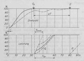
Die gestrichelten Linien schliessen das Feld ein, in welchem die Turbinenleistung  $P_a$  je nach Einstellung der Anfahrstatik ansteigen kann; die ausgezogene Linie entspricht einer mittleren Einstellung
