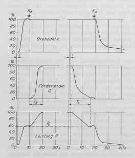
Bild 3. Vorgänge beim Anfahren und Abstellen einer Pumpe mittels Synchronwandlers
