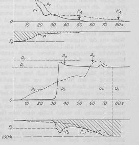
$Q_{\rm n}\,/\,Q_{\rm v}$  volle Förderung erreicht bei einer Pumpe mit horizontaler / vertikaler Welle
