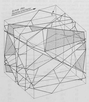
Bild 6. Kluftdiagramm für den rechtsufrigen Sondierstollen I
