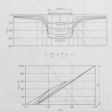
Bild 8. Ergebnisse eines Verformungsversuchs senkrecht zur Hauptklüftung im linksufrigen Sondierstollen II; oben Einsenkungsbilder für verschiedene Laststufen, darunter mittlere Platteneinsenkung in Funktion der Belastung
