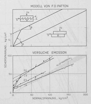
Bild 9. Zusammenfassung der Resultate der Modellversuche von F. D. Patton über die Scherfestigkeit glatter und verzahnter Kluftflächen (oben) und Vergleich mit den Ergebnissen der Scherversuche parallel zur Hauptklüftung in beiden Sondierstollen Emosson (unten) sowie an Kluftmaterial (punktierter Bereich)
