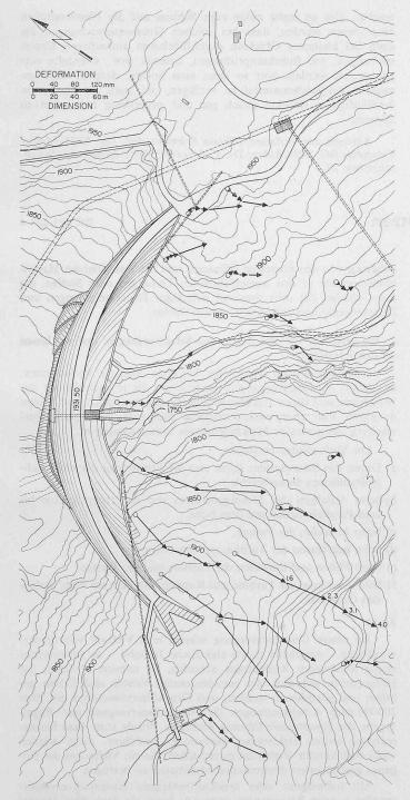
Bild 12. Am geomechanischen Modell gemessene horizontale Gesamtverformungen des Felsuntergrundes, je bei 1,6-, 2,3-, 3,1- und 4facher Wasserlast (Mauergrundriss entspricht Vorprojekt)
