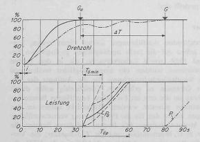
Die gestrichelten Linien schliessen das Feld ein, in welchem die Turbinenleistung  $P_a$  je nach Einstellung der Anfahrstatik ansteigen kann; die ausgezogene Linie entspricht einer mittleren Einstellung
