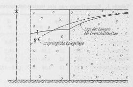
Bild 3. Verschiebung der Spiegellage bei fortschreitender Versandung (schematisch)
