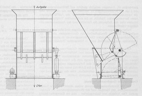
Bild 8. Aufgabetrichter mit Brechvorrichtung an der engsten Stelle. Darunter Abschlussklappe gegen Rückbrand, mit gekühlter Welle
