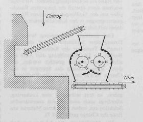
Bild 2. Doppelrotor-Hammermühle, gespeist mittels Aufgabeband. Abzug des gemahlenen Gutes durch gepanzertes Förderband. Die Zerkleinerung ist in der Regel feiner als für die Verbrennung auf dem Rost nötig. Nebst der Lärmentwicklung ist die Explosionsgefahr zu erwähnen, die bei der verhältnismässig kleinen Kubatur der Maschine zu Unfällen führen kann
