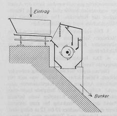
Bild 1. Prallmühle für Grobzerstückung, mittels Schüttelrinne gespeist. Grosse Einwurföffnung. Beträchtliche Lärmentwicklung, daher nicht überall verwendbar
