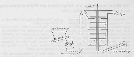
Bild 5. Etagenofen mit vorgeschalteter Hammermühle, Förderung des Materials aus dem Einwurfbunker in die Mühle, von der Mühle in den Ofen und vom Ofen in den Aschesilo mittels Förderbändern oder Kettenförderern. Die heissen Rauchgase streichen im Gegenstrom zum Brennstoff; die Welle mit den Rührarmen ist luftgekühlt
