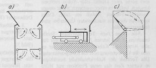
Bild 6. Drei Methoden der Aufgabe ohne dichtenden Füllschacht:
