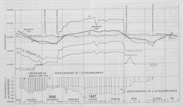
Bild 6. Verlauf des Grundwasserspiegels während der Bauzeit
