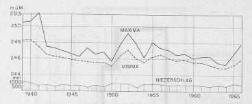
Bild 3. Grundwasserspiegel, jährliche Minima und Maxima
