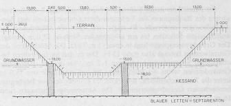
Bild 5. Schnitt durch Baugrube, 1:1000
