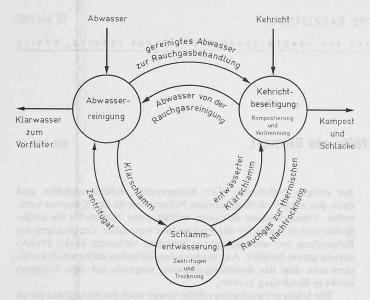
Bild 1. Schema (Kombination Abwasser + Kehricht + Schlamm)
