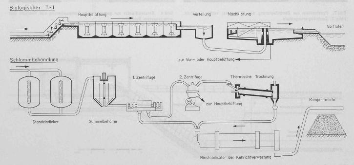
Bild 4. Schema der Anlagen zur Abwasserreinigung und Schlammbeseitigung
