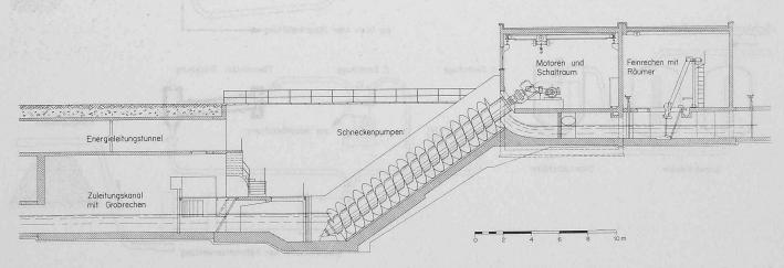
Bild 9. Einlaufpumpwerk, 1:300
