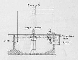
Bild 5 (oben). Steuerung des Sauerstoffeintrages in die Belüftungsbecken, 1:300
