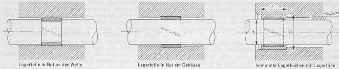
Bild 6. Einbau- und Befestigungsbeispiele von Schlitzringlagern aus PTFE
