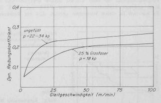
Bild 5. Dynamischer Reibungskoeffizient von PTFE in Funktion der Gleitaeschwindigkeit
