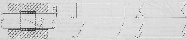
Bild 7. Bewährte Einbauverhältnisse und Folienzuschnitte für Schlitzringlager aus PTFE. Links Einbauverhältnisse, s Foliendicke. 1 bis 4 typische Endschnitte
