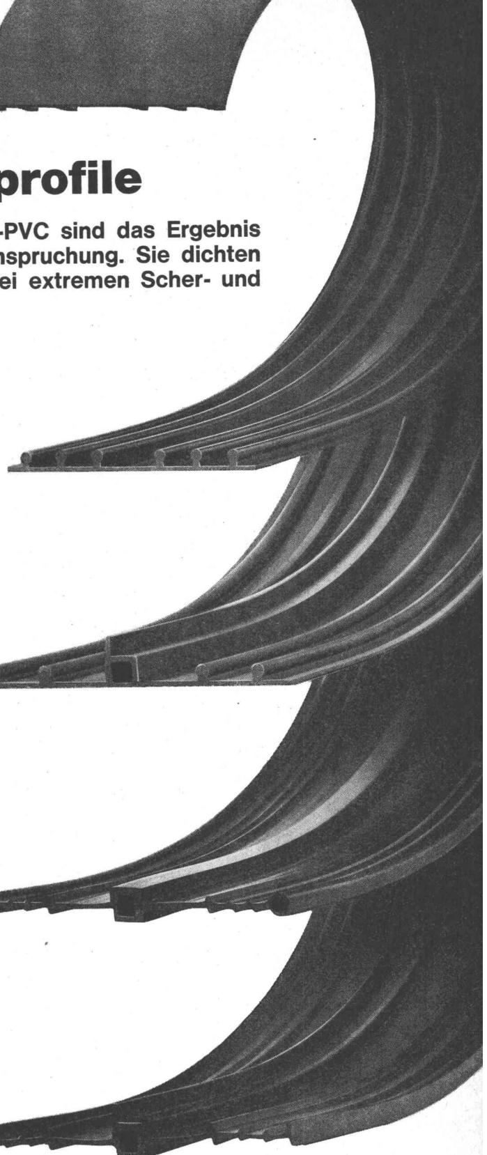
**D0 25 - Oberflächenband für Dilatationsfugen** mit geringen Dehn- und Scherbewegungen bei mässigem Wasserdruk. Einbau auf der Wasserseite des Betons (nur auf Sauberkeitsschicht oder in äussere Schalung legen).
