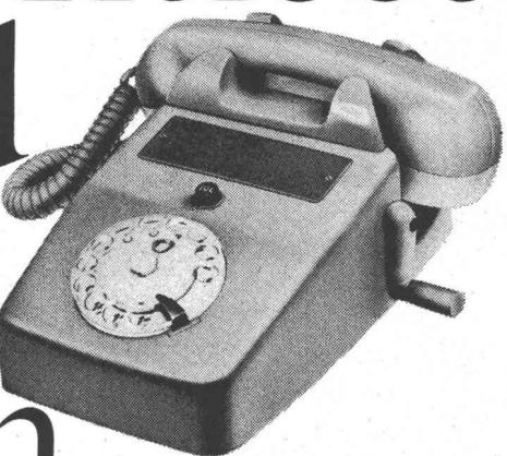
Batterielose Telefonanlagen sind unabhängig von anderen fremden Stromquellen: Der Sprechstrom wird von der im Handapparat befindlichen magnetischen Mikrofonkapsel, der Rufstrom vom Kurbelinduktor in der Telefonstation erzeugt. So ist stets ein sicherer Betrieb gewährleistet.
