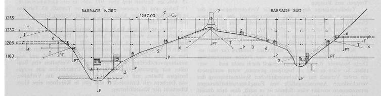
Bild 3. Ansicht der Mauern, Anordnung der Messungen
