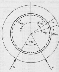
Bild 6. Eingeführte Kräfte am Ring zur Berechnung der Randbedingungen für das Rohr
