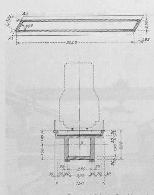
Bild 3. Abmessungen der Eisenbahnbrücke im Grundriss und Querschnitt
