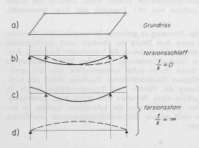
Bild 2. Lagerkräfte eines torsionsschlaffen und eines torsionsstarren schiefen, zweistegigen Einfeldträgers
