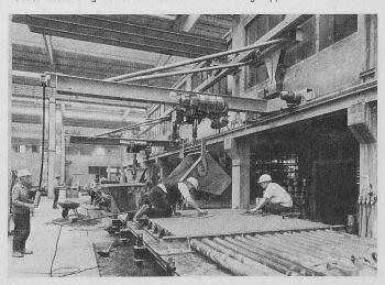
auf einer rund 40 m langen Fahrbahn zwei Konsolkrane mit einer Tragfähigkeit von 3 t und einer Ausladung von 5 m über Rütteltischen. Mit  $\nu=30/7,5$  m/min bewegen sich diese beiden Konsolkrane – die man allgemein zur Entlastung der auf höherer Transportebene arbeitenden Laufkrane einsetzt – auf einer gemeinsamen Fahr- und Stützschiene in etwa 4 m Höhe über Hallenflur (Bild 2).
