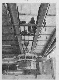
Bild 6. 2-Träger-Laufkrane. 10 t Tragkraft, 15 m Spannweite (Beton-Vorfabrikation Modul, Basel)
