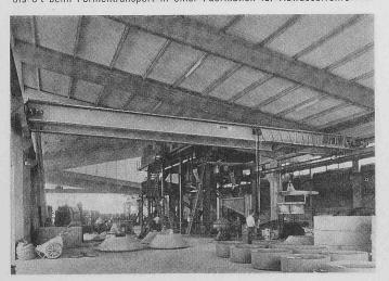
verglasten Fenstern versehenen Bauteile an einer verstellbaren Hakentraverse mit dem Kran sanft aufgenommen auf Tieflader für den Versand abgesetzt werden.
