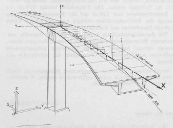
Bild 11. Doppelkonsoltyp mit veränderlicher Geometrie, Definition der Axensysteme
