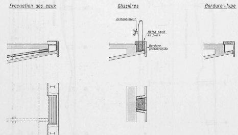
Die zugelassenen Toleranzen liegen in der Ordnung von 2 mm für die Elemente. Dies wird erreicht durch den Gebrauch von sehr starren Stahlschalungen, die ständig gerichtet und überprüft werden. Dazu wird für jedes Element ein Typenplan erstellt mit Angaben der einzuhaltenden Masse in Tabellenform (gemäss einem System, das den Gebrauch einer elektronischen Einrichtung für die automatische Einregulierung der Schalung erlaubt).
