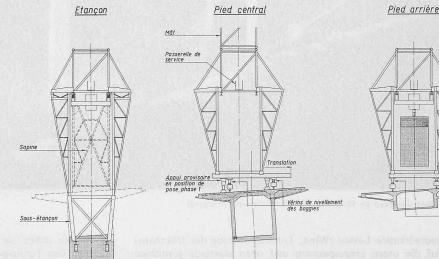
Bild 12. Versetzkran mit veränderlicher Geometrie
