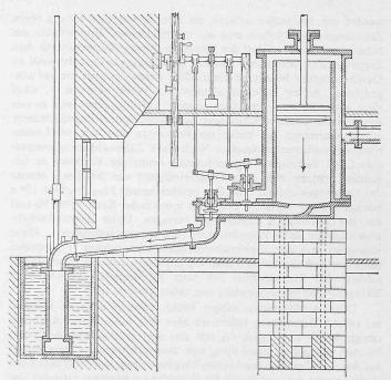
Bild 2. Wattsche Dampfmaschine aus dem Jahre 1769, die dem Patent entsprach, entnommen aus [1], S. 67.
