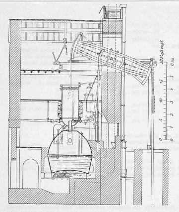
Bild 1. Von John Smeaton erbaute, verbesserte Newcomensche Feuermaschine von etwa 40 PS, entnommen aus [1], S. 51.
