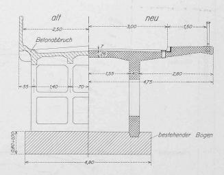
Bild 8. Längsschnitt der umgebauten Aarebrücke in Aarburg, 1:500
