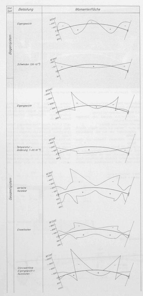
Momente im Bogen aus Eigengewicht unter 500 mt zu reduzieren, was einer Ausmittigkeit der Bogennormalkraft ( $N \approx 1800 \, \mathrm{t}$ ) von einem Drittel der Bogenstärke entspricht. Andererseits würden die Nutzlasten zu grosse Beanspruchungen und Deformationen im Bogen bewirken, wenn dieser nicht horizontal unverschieblich festgehalten würde<sup>1</sup>). Die dabei nötigen Stossdämpfer sind aber kostspielig und bedingen komplizierte Einrichtungen.
