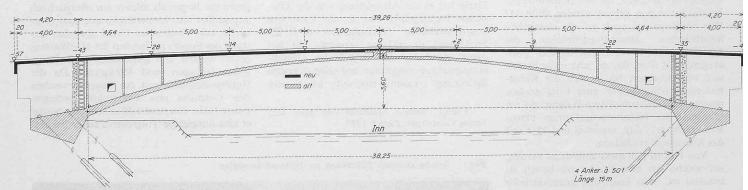
Bild 3. Längsschnitt der Inn-Brücke bei Zuoz, 1:250
