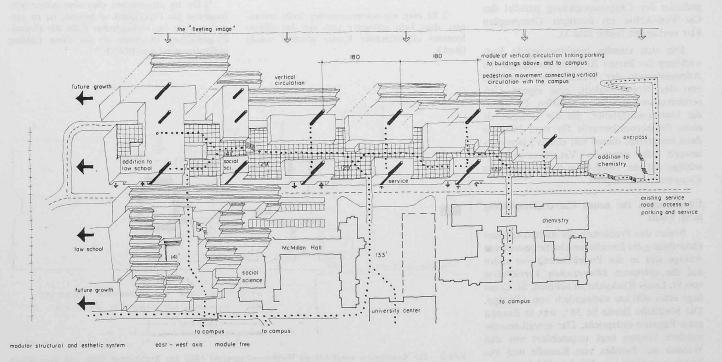
Bild 4. Die Trennung des Auto- und Fussgängerverkehrs, bezogen auf die Hauptfussgängerebene (level 123', vgl. Bild 9). Brückenverbindungen über die Anlieferungsstrasse zum bestehenden Campus. Liftstränge modular verteilt. Kariert: Fussgängerebene; punktiert: Fussgängerverkehr; gestrichelt: Fahrverkehr
