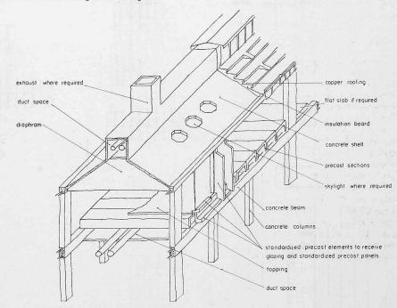
Bild 7. Systemskizze mit den Möglichkeiten des Elementhaus und der horizontalen Installationsverteilung usw.
