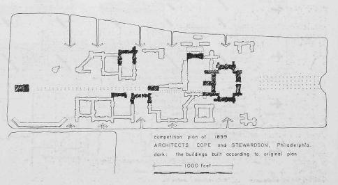
Bild 2. Zur Ausführung empfohlenes Wettbewerbsprojekt 1899 der Architekten Cope und Stewardson (Gesamtplan). Die zusammenhängenden Innenhöfe sind durch Fussgängerpassagen (Ost-Westachse) verbunden. Dienstzugänge von Norden und Süden. Dieses Konzept soll grundsätzlich beibehalten werden
