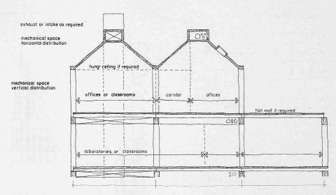
Bild 6. Typischer Querschnitt durch das Bausystem, dessen Masse erlauben Büros, Seminarräume, Labors usw. zweckmässig unterzubringen
