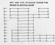
Bild 5. Gleichbleibende Achsabstände (6 m) in Nord-Südrichtung bilden das strukturell-ästhetische Grundsystem. Die Stützenabstände der Ost-Westachse sind frei wählbar gemäss den Erfordernissen der Planung (Norden oben)
