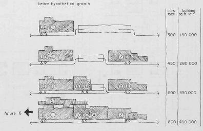
Bild 8. Eine der Möglichkeiten für das strukturelle Wachstum. Die Parkplätze mehren sich mit der Zunahme der Bruttogeschossfläche, Endausbau: 800 Parkplätze auf 49 000 m² Bruttogeschossfläche
