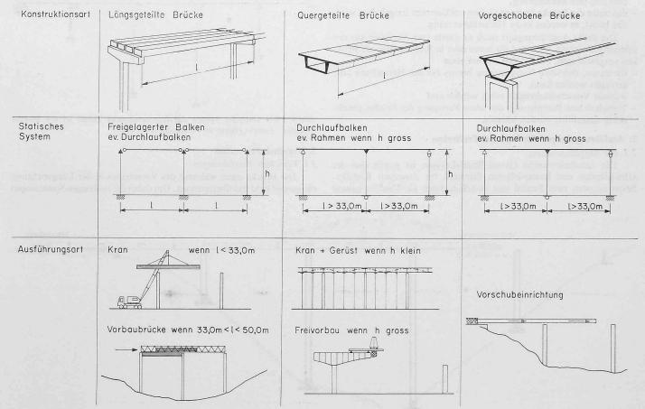
Bild 1. Systeme im rationalisierten Brückenbau
