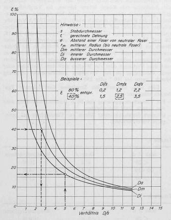
Bild 2. Dehnung in der Randzone von Faltbiegeproben (aussen bzw. innen) gerechnet aus  $\epsilon=\frac{e}{r_{\rm m}}=\frac{s}{D_{\rm m}}=\frac{s}{r_{\rm m}}\times 50~(\%)$
