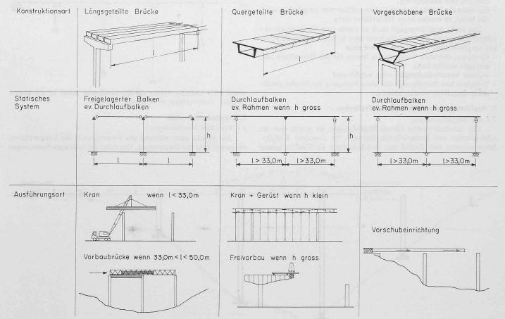
Bild 1. Systeme im rationalisierten Brückenbau
