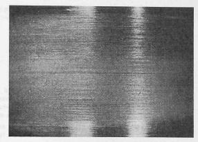
von 58 HRc, die Grundmasse eine Härte von 64 HRc aufweist. Der Versuch wurde mit einem Fett ausgeführt, dessen Grundöl eine Viskosität von 60 cSt hatte.
