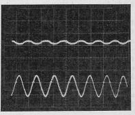
Bilder 10a und 10b. Bei Versuchen mit Wechselstrom aufgezeichnete Spannungs- und Stromkurven
