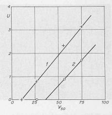
schiedener Grundöl-Viskosität fortgesetzt. In Tabelle 1 ist die in verschiedenen Fällen gemessene Frittspannung angegeben; aus Bild 9 geht hervor, dass ein nahezu linearer Zusammenhang mit der Viskosität des im Fett enthaltenen Öles besteht.
