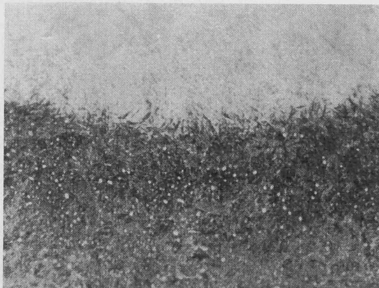
Bilder 6a und 6b. Mikroaufnahmen einer Schliiffprobe durch Krater in einem durch Stromdurchgang beschädigten Lagerring
