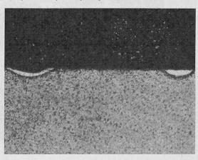
das heisst, die Spannung an den Lagern darf unter keinen Umständen 0,4 bis 0,8 V übersteigen. Anderseits hat man aber auch keine Gewähr gegen das Auftreten von Stromschäden, wenn die Spannung kleiner als die angegebenen Werte ist.
